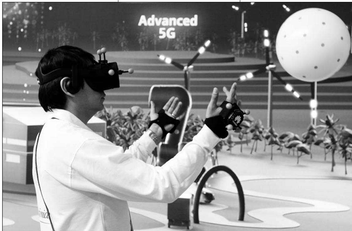
Combinan la transmisión de vídeo de alta definición con la recepción de información virtual localizada, lo que permite componer en la pantalla (en este caso unas gafas) una imagen real con imágenes virtuales.
