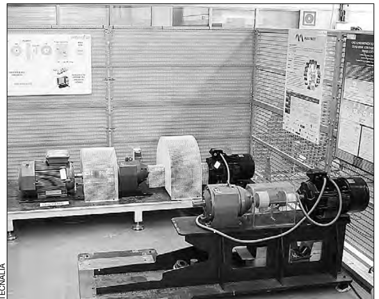
El Laboratorio Eléctrico de TecNALIA permite simular el comportamiento de la turbina de cualquier convertidor de energía marina.
