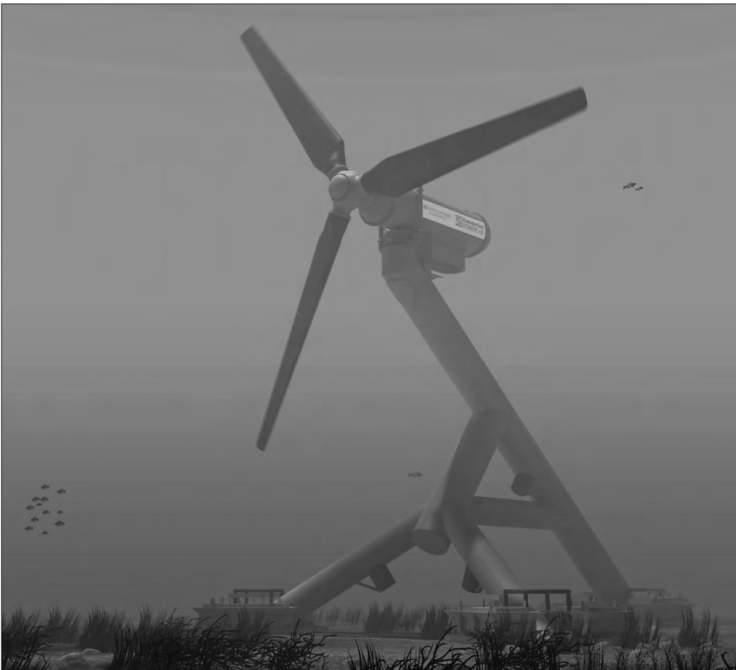
Hammerfest Strom, socio tecnológico de Iberdrola, prueba este generador de 1 MW para el aprovechamiento de la energía de las corrientes en la isla de Islay (Escocia).
